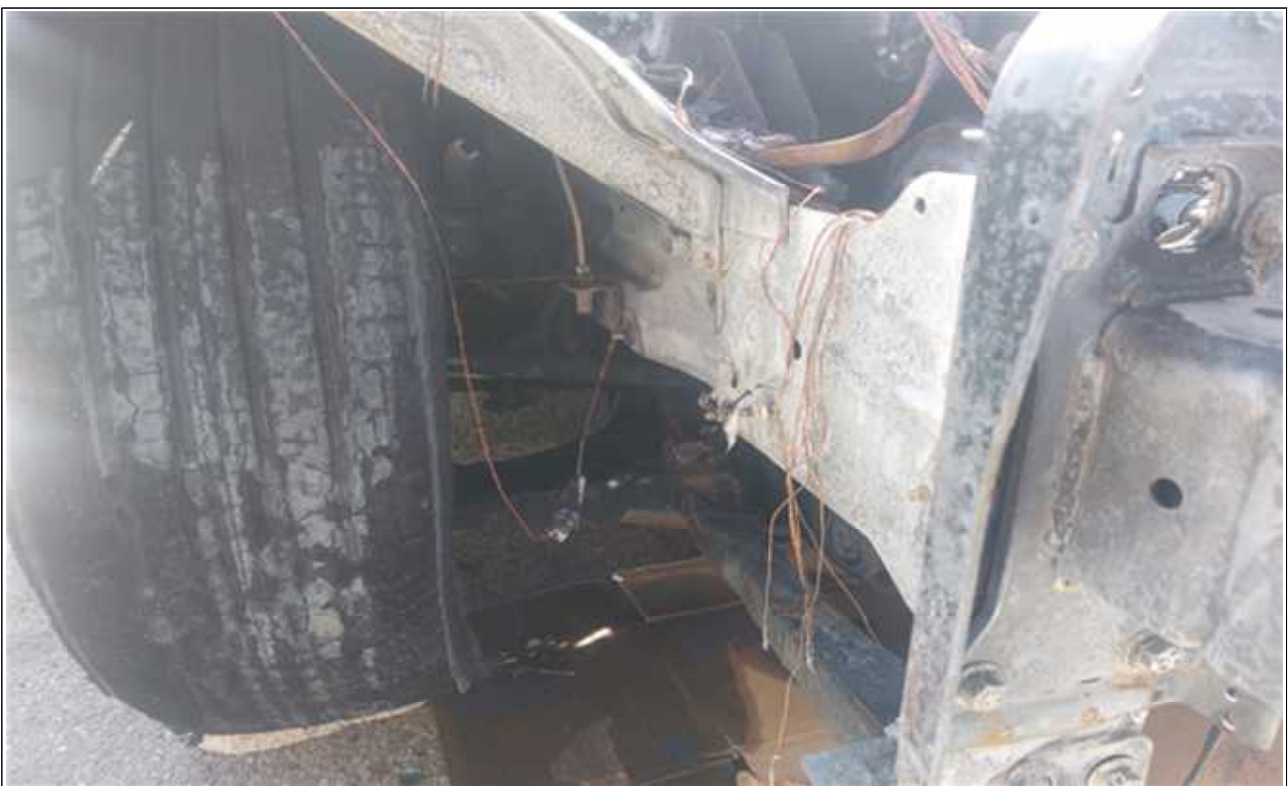
사진 11 조수석 하부-화재의 원인이 될 물적증거 식별되지 않음
