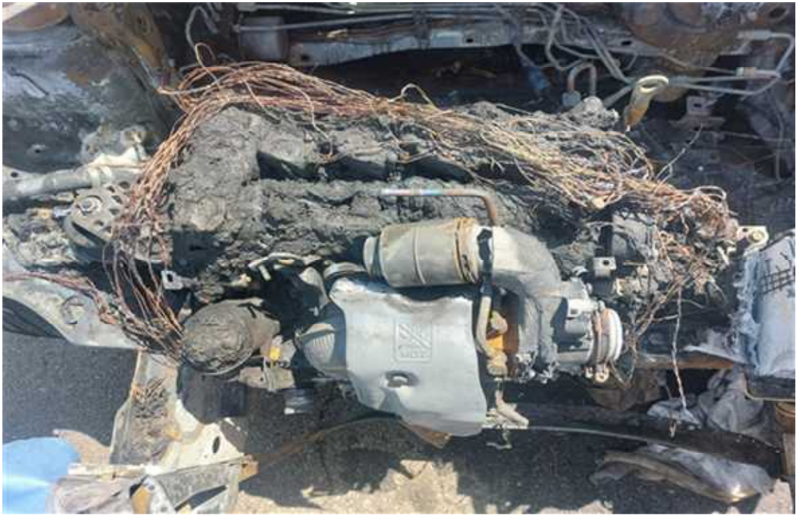
사진 12 터보차저 및 엔진커버 소실흔적-특이점 없음
