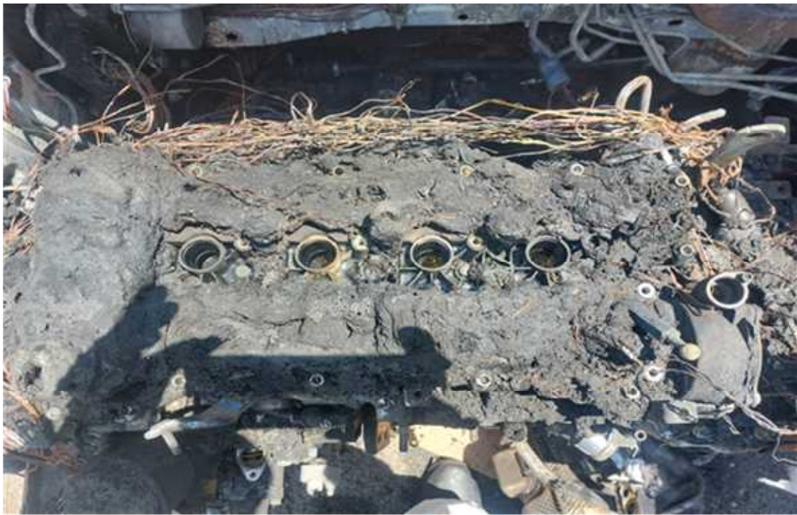
사진 14 엔진 상부 커버제거 전-점화코일 접속부 특이점 없음
