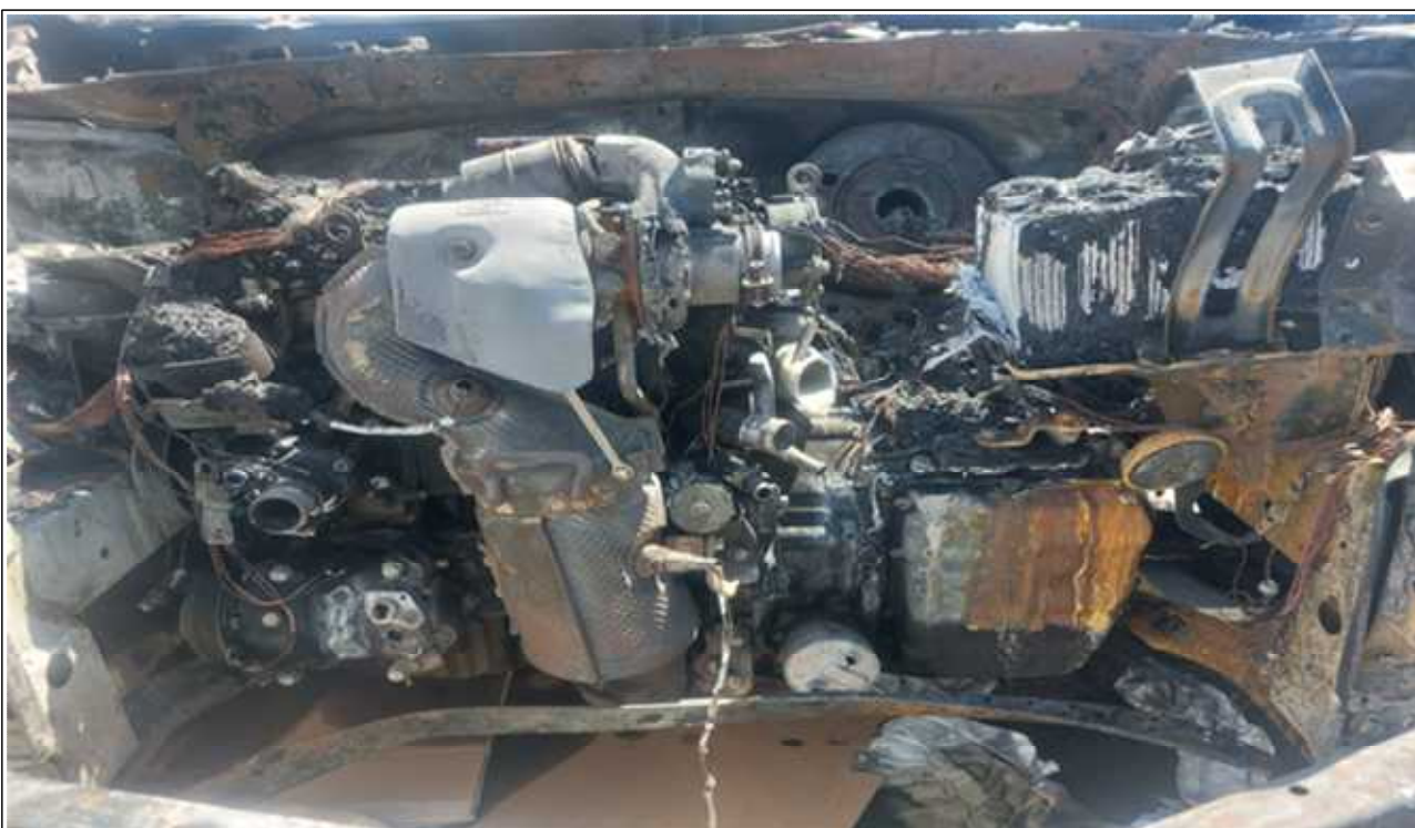
사진 9 차량 전면부-내부 윤활유가 확인이 되며, 화재 특이점 없음
