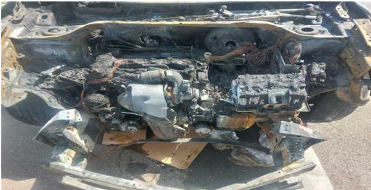
사진 6 | 전면부 터보차저 및 배터리함, 화재로 인한 특이점 없음
